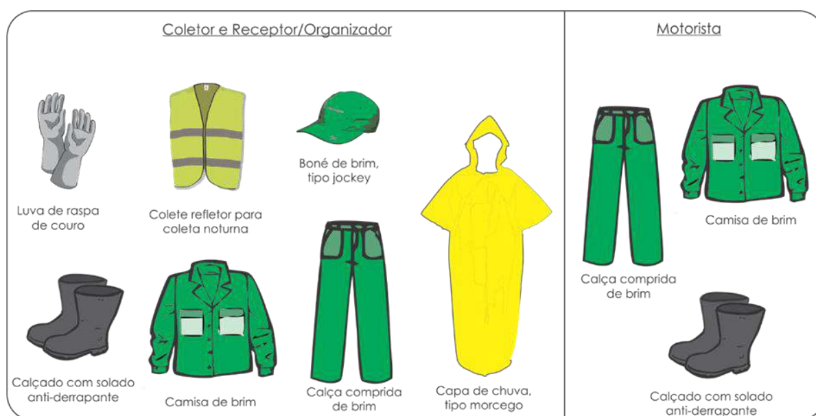
Figura 145 – Equipamentos de Proteção Individual recomendados para as guarnições de coleta seletiva dos municípios abrangidos pelo PIGIRS-CONISUL.
