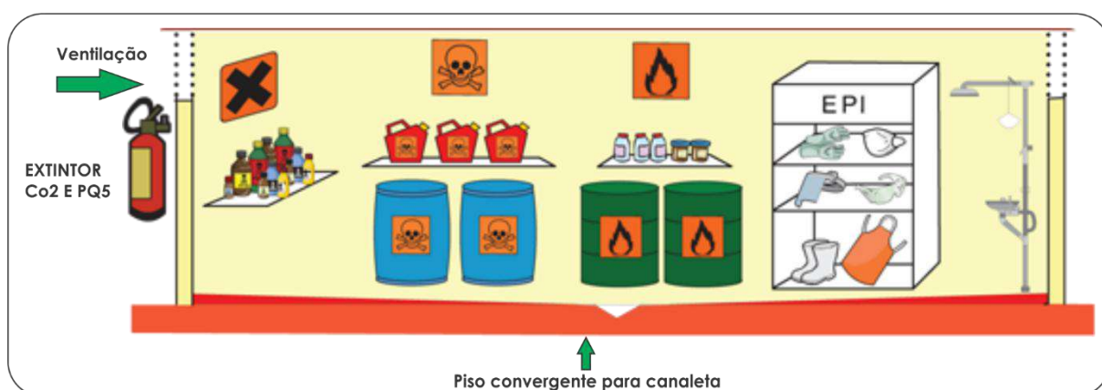
Figura 161 – Ilustração de um abrigo de resíduos do Grupo B.
