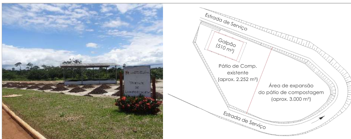
Figura 131 – Unidade de compostagem do município de Rio Branco/AC, detalhando através de croqui sua implantação.
