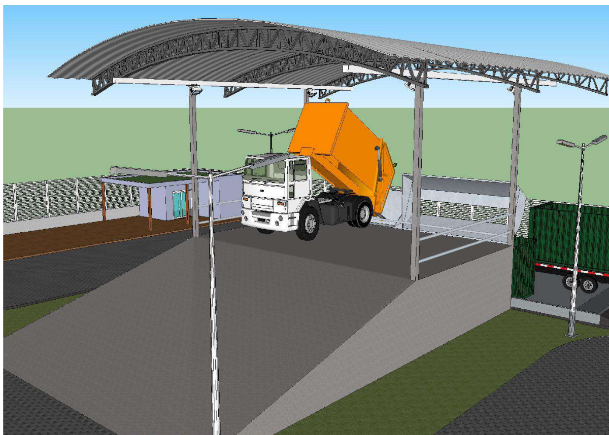
Figura 128 – Layout de uma Unidade de Transbordo do tipo “estação de transbordo com armazenamento” que utiliza dispositivo de acondicionamento em contêineres.
