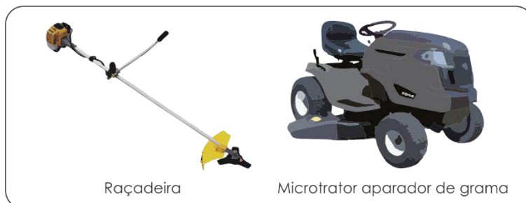
Figura 152- Exemplo de equipamentos mecânicos para o serviço de roçada.
