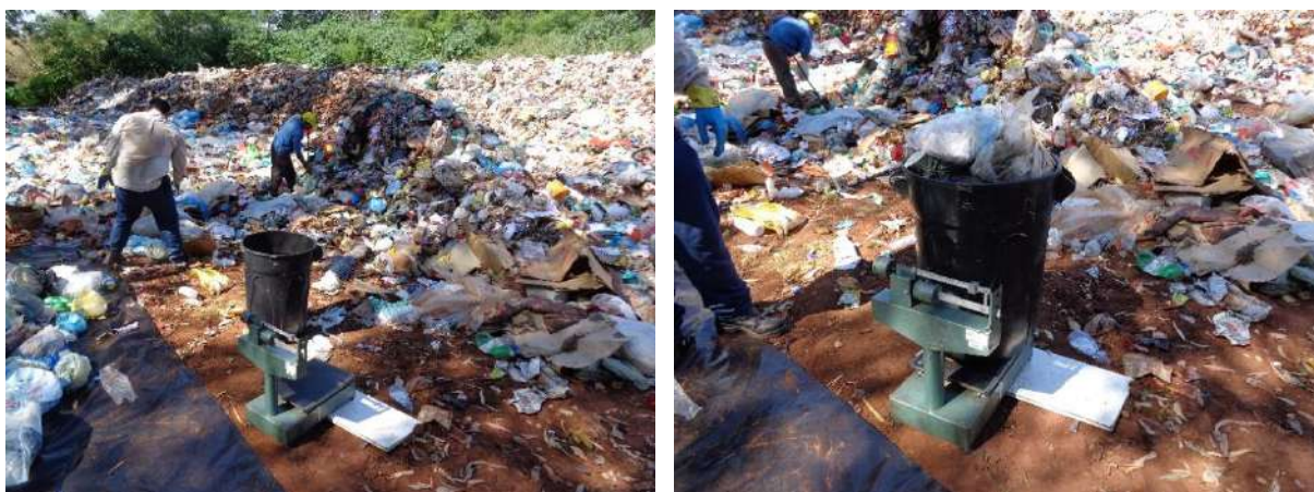
Figura 56 - Realização do ensaio de determinação da massa específica aparente dos resíduos domiciliares, comerciais e de prestadores de serviços de Tacuru/MS.
