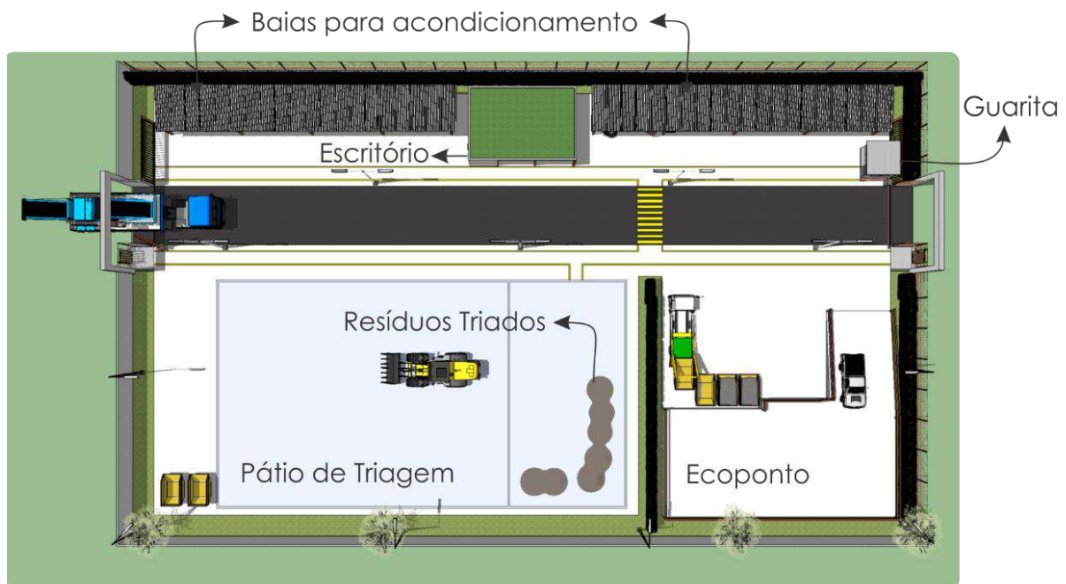
Figura 137 – Layout típico de uma Área Integrada de Recebimento, Triagem e Transbordo de RCC para os municípios integrantes do PIGIRS-CONISUL.
