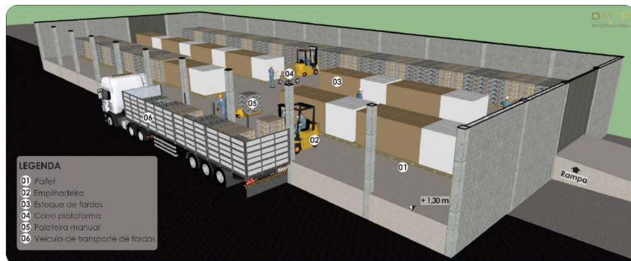
Figura 62 – Detalhe em perspectiva do setor de estocagem e expedição de fardos previsto a partir do ano de 2030.
