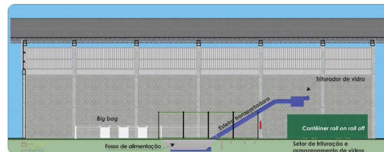
Figura 59 - Detalhe em corte do setor de trituração de vidro que deverá ser operado a partir do ano de 2025.
