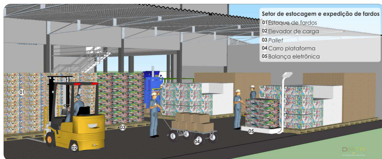
Figura 74 - Setor de estocagem e expedição de fardos previsto para os galpões de triagem. Fonte: Elaborado pelos autores.
