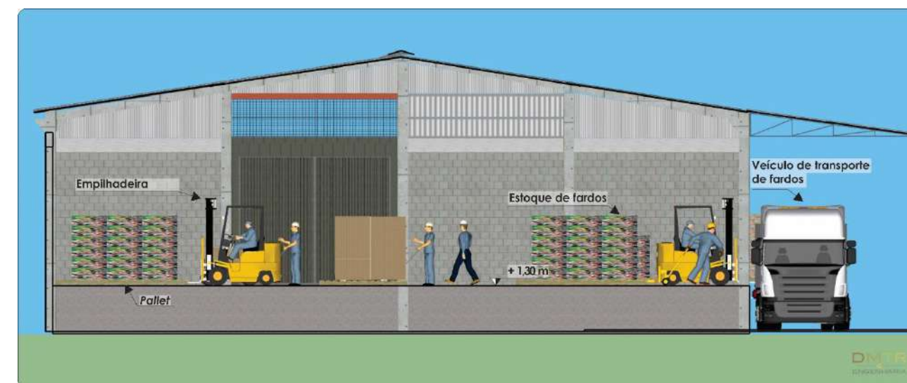
Figura 61 - Corte transversal do setor de estocagem e expedição de fardos previsto a partir do ano de 2030 destacando o desnível facilitador da operação de carga.
