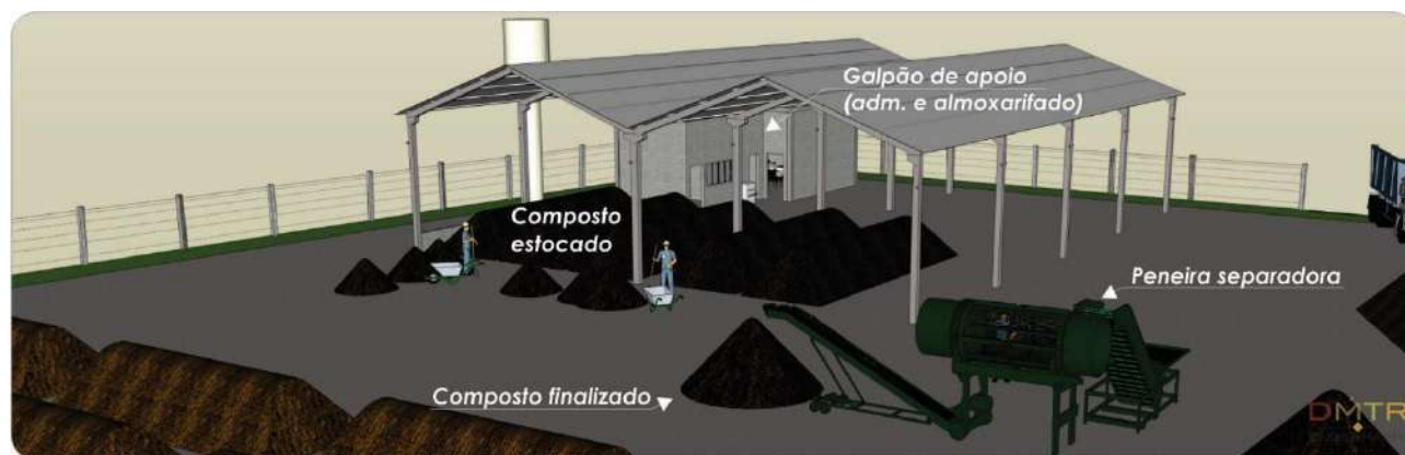
Figura 85 - Layout do setor de acondicionamento e expedição do composto finalizado.
