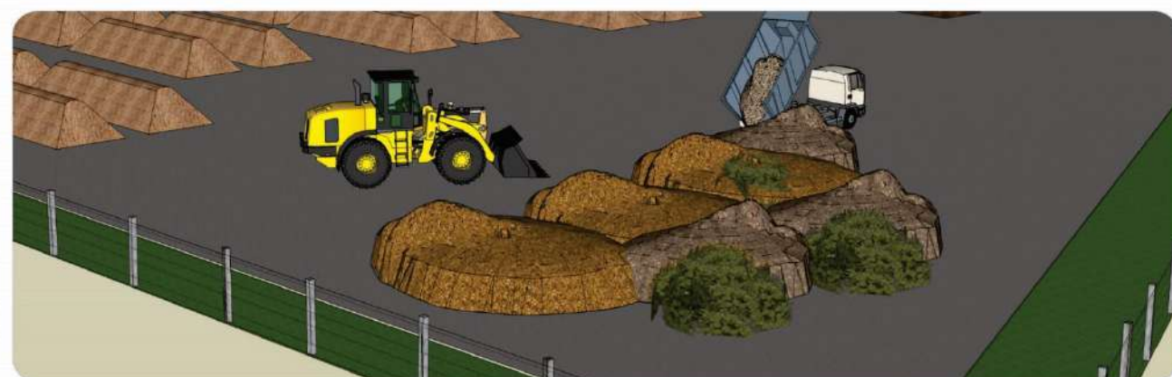
Recepção, inspeção e mistura para montagem das leiras
