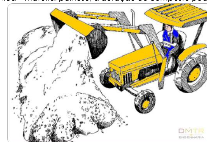
Figura 79 - Processo de mistura e formação da leira.
