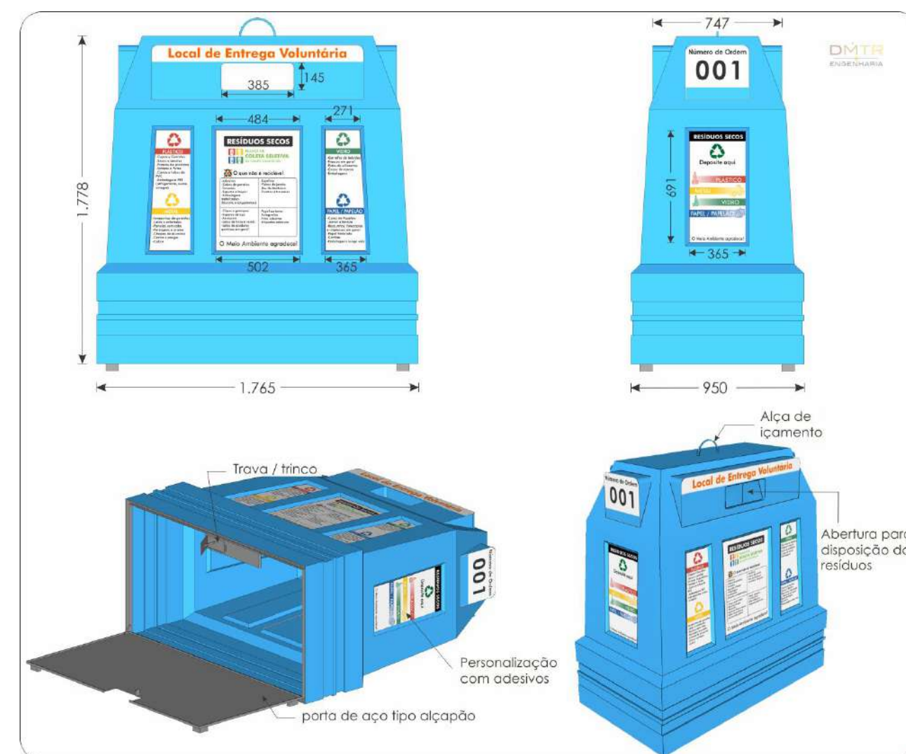
Figura 5 - Principais aspectos construtivos do dispositivo de acondicionamento de PELBD a ser utilizado nos LEVs.
