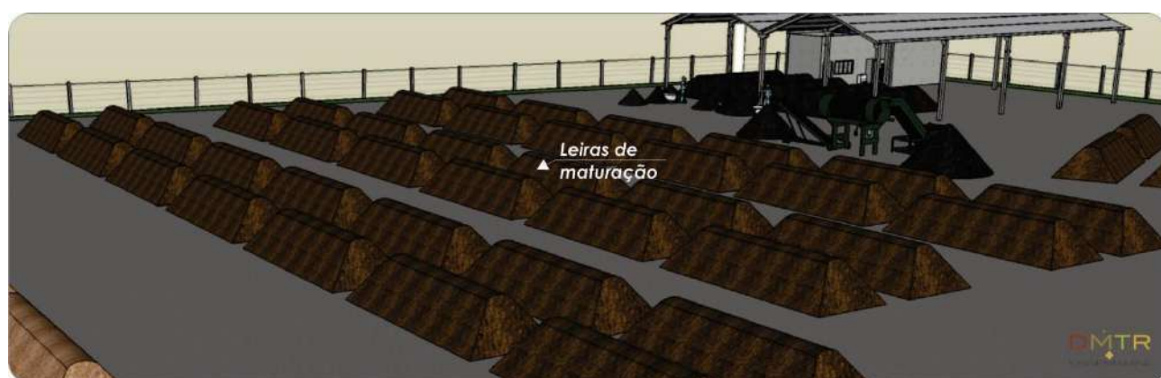
Figura 83 - Esquematização do setor de maturação da Unidade de Compostagem Municipal.
