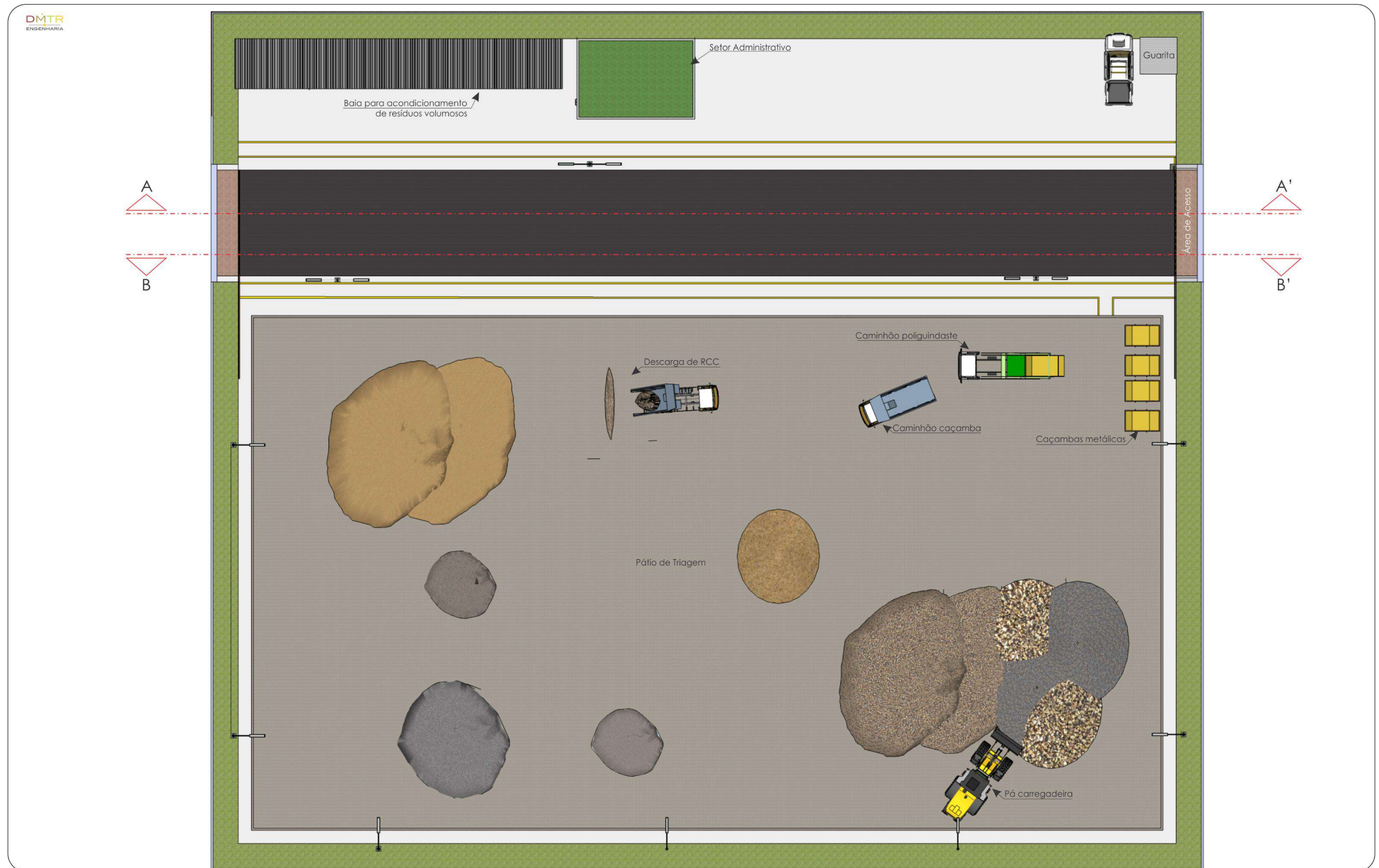
Figura 101 - Vista em planta da proposta para ATT Imbirussu, contendo as informações gerais das instalações e equipamentos. Fonte: Elaborado pelos autores.
