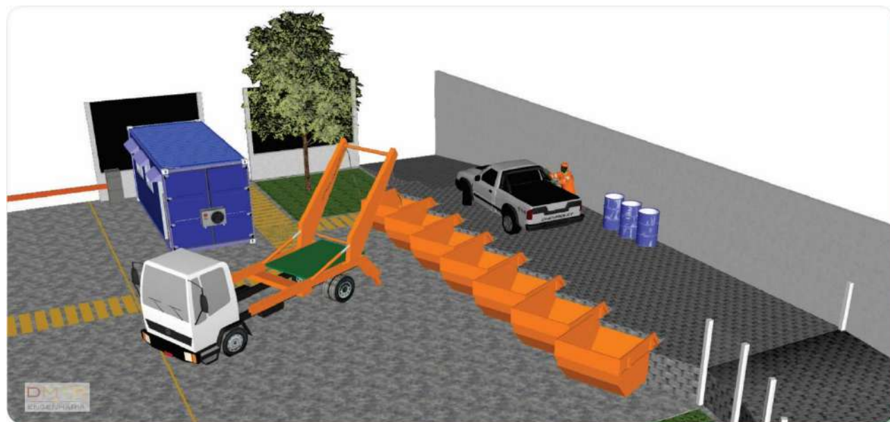
Figura 96 - Setor de recepção de pequenos volumes para acondicionamento em caçambas metálicas.
