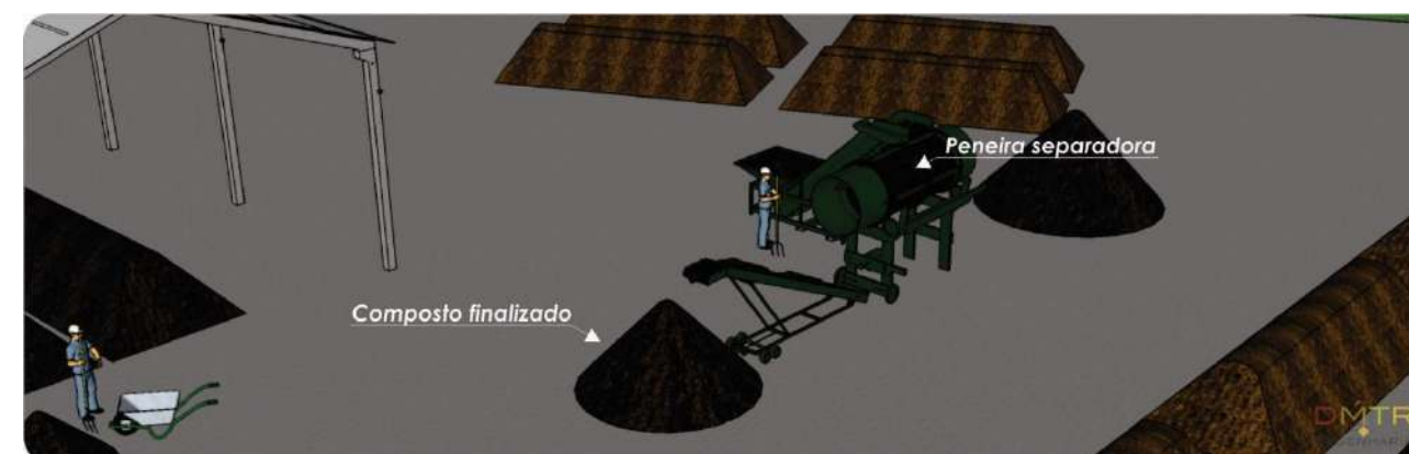
Figura 84 - Layout esquemático ilustrando o equipamento necessário para o peneiramento do composto após maturação.
