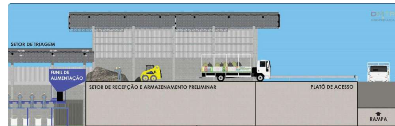
Figura 54 - Detalhe do desnível existente entre o setor de recepção e armazenamento preliminar e o setor de triagem primária e secundária.
