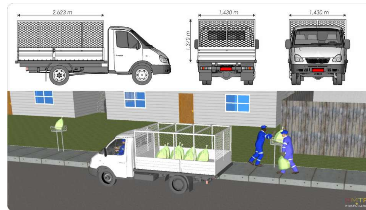
Figura 119 - Ilustração esquemática do veículo coletor da coleta seletiva PaP em espiral.
