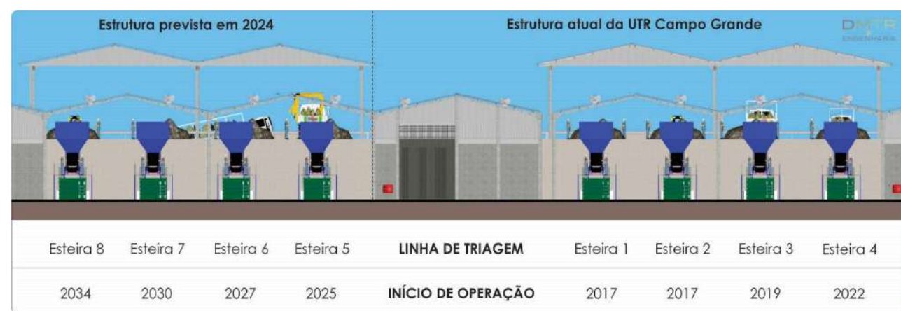
Figura 55 – Corte transversal do setor de triagem primária e secundária da UTR Campo Grande destacando as linhas de triagem e seus respectivos anos de início de operação.
