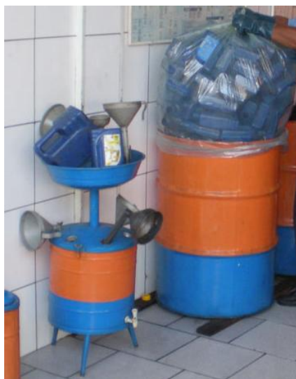
Figura 58 - Ponto de recebimento de embalagens plásticas usadas de lubrificantes em um posto de serviço.
