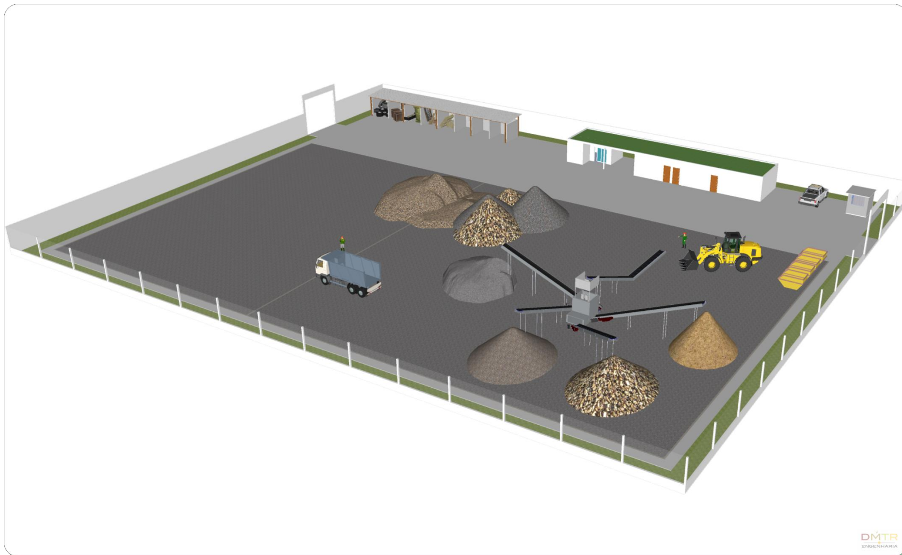
Figura 36 - Layout típico de uma Área de Transbordo e Triagem (ATT).
