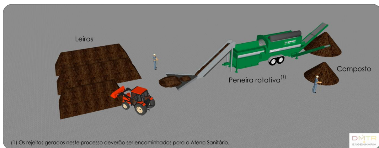
Figura 35 – Ilustração esquemática destacando as “peneiras rotativas” de uma Unidade de Compostagem.
