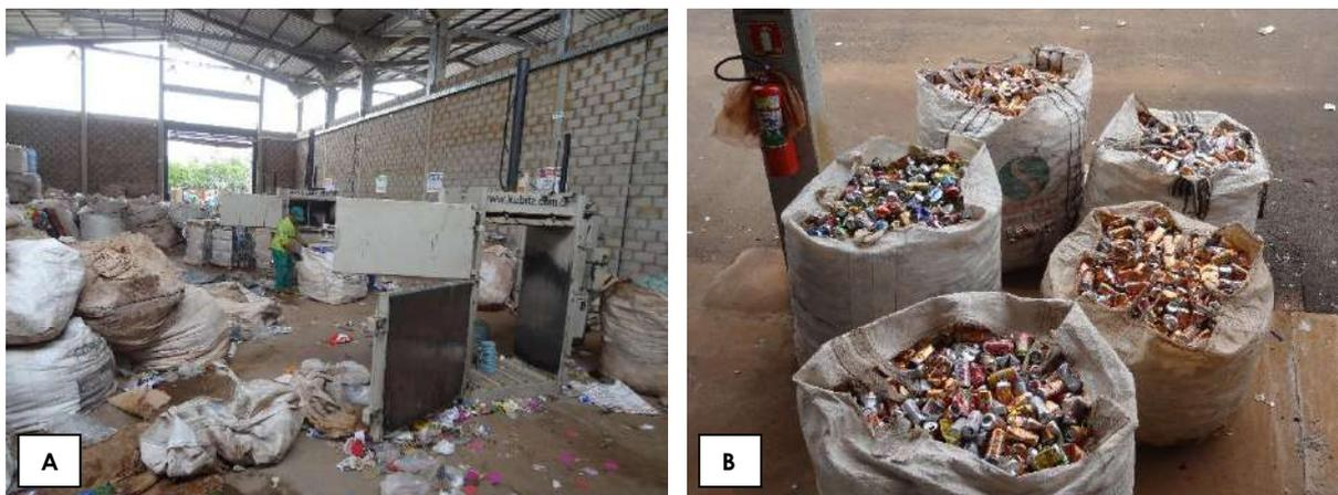
**Figura 117: (A) Prensas enfardadeiras hidráulicas do tipo vertical e (B) Bags com materiais recicláveis.**
