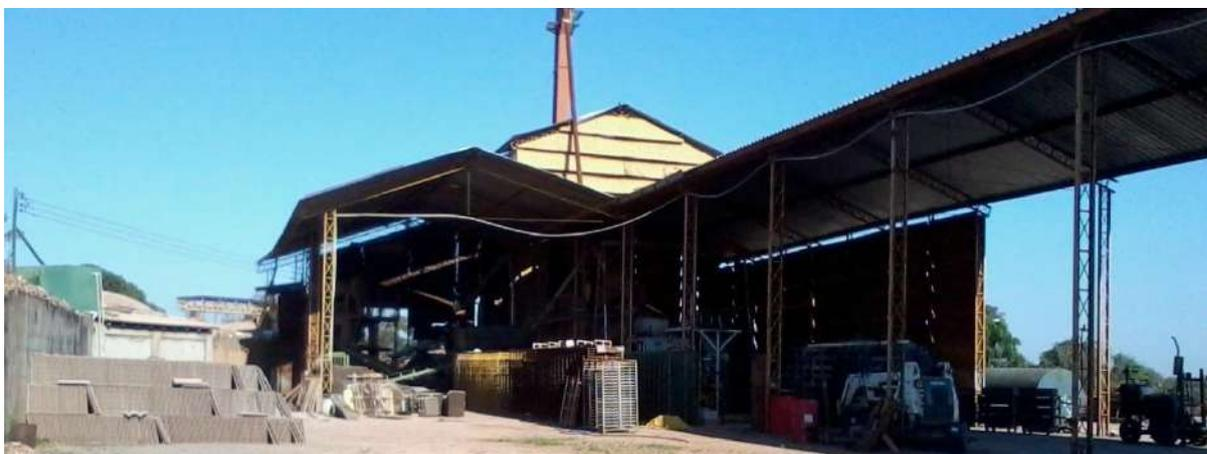
**Figura 71 – Empresa Resilix do Brasil que realiza o beneficiamento e reciclagem de resíduos da Classe A (sobras de concreto, componentes cerâmicos e sobras de argamassa) no município de Campo Grande**
