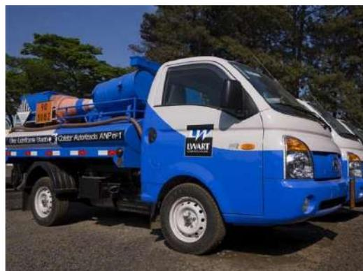
**Figura 81 - Veículo coletor de óleo lubrificante usado pela empresa Lwart Lubrificantes.**
