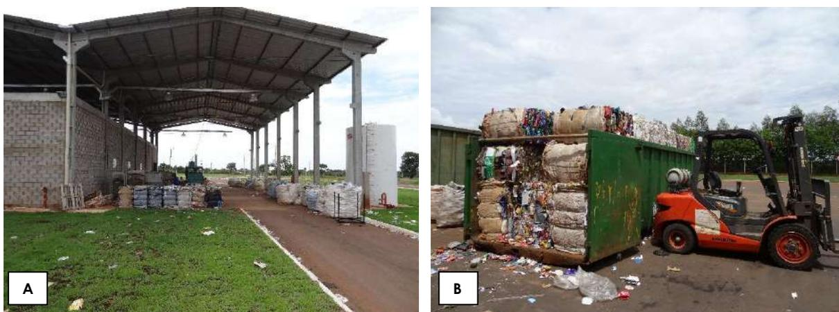
**Figura 118: (A) Setor de estocagem e expedição de fardos; (B) Contêiner com os fardos e elevador de carga (empilhadeira).**
