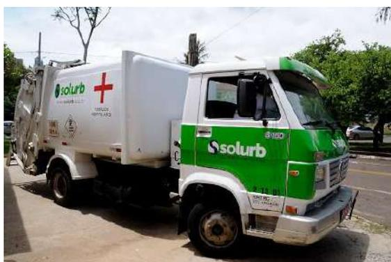
**Figura 89 - Veículo coletor de RSS potencialmente infectante e/ou perfurocortante.**
