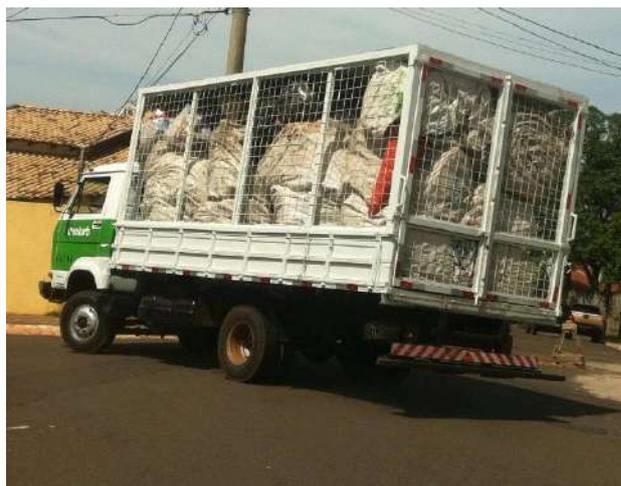
**Figura 99 - Veículo coletor com implemento do tipo gaiola utilizado para a coleta seletiva em LEVs.**
