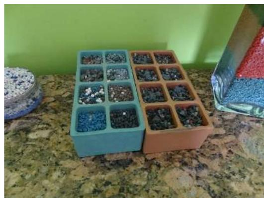
**Figura 150 – Material plástico granulado após recuperação**
